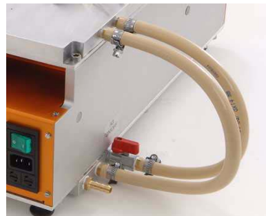
Illustration 8. Connexion pompe à vide et valve de contrôle
