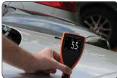
Mediciones en paneles de carrocería de acero y aluminio²
